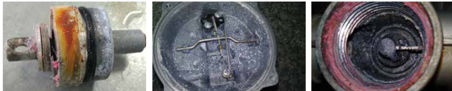
Рис. 3. Следы окисления внутренних узлов арматуры
